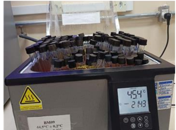
Figura 11 – Incubação de amostras à temperatura de 44,5 \pm 0,2 °C para o teste confirmatório de organismos termotolerantes
