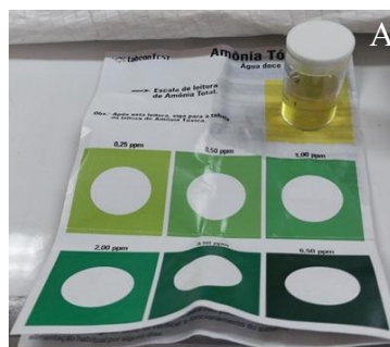
Figura 12 – Kits colorimétricos utilizados para determinação de amônia (A) e nitrito (B) e amostras de água em procedimento de análise (C) com os kits colorimétricos
