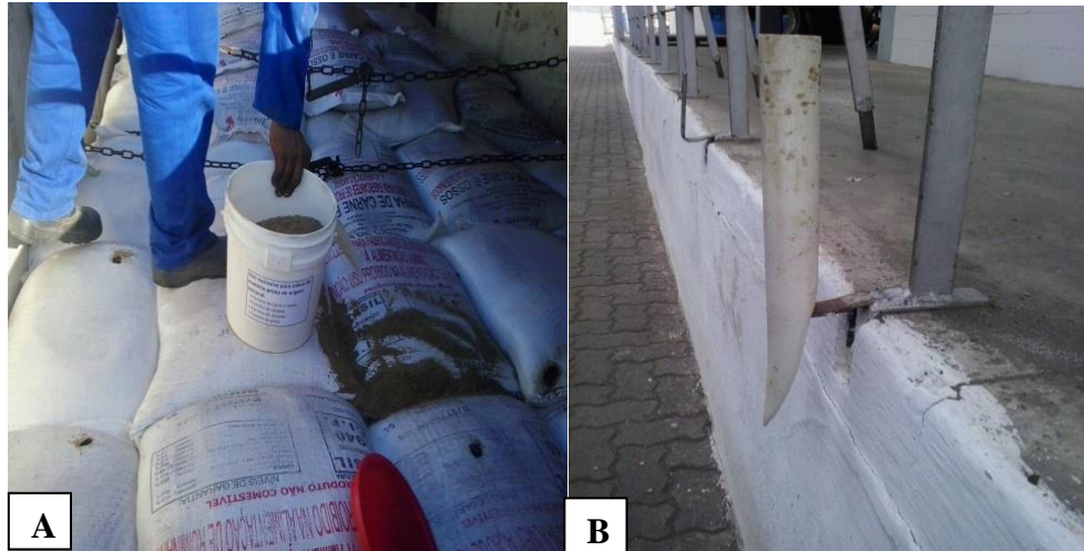
Figura 3 - Coleta de amostra de produto ensacado (A) e calador simples (B)
