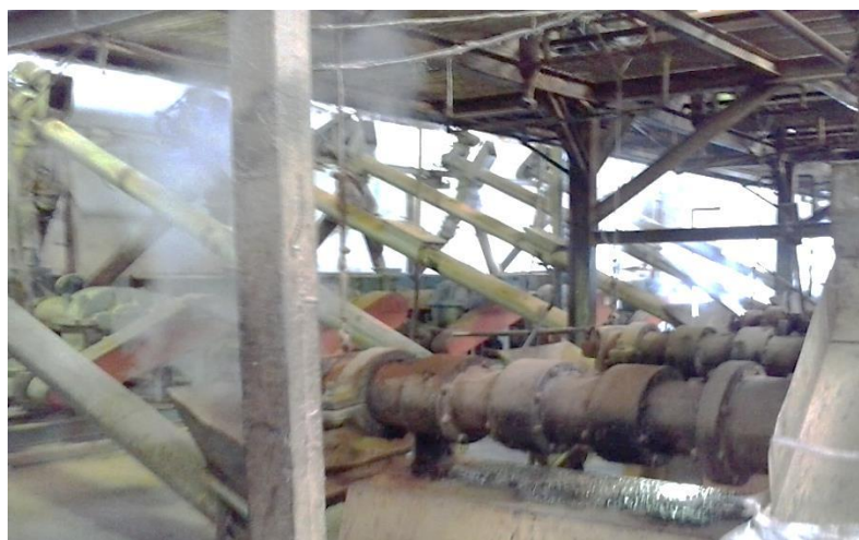
Figura 18 - Máquinas extrusoras ligadas às prensas.
