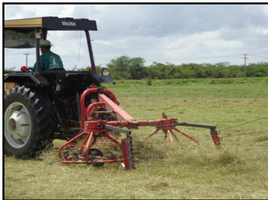
Figura 5 - Ancinho espalhando a forragem cortada
