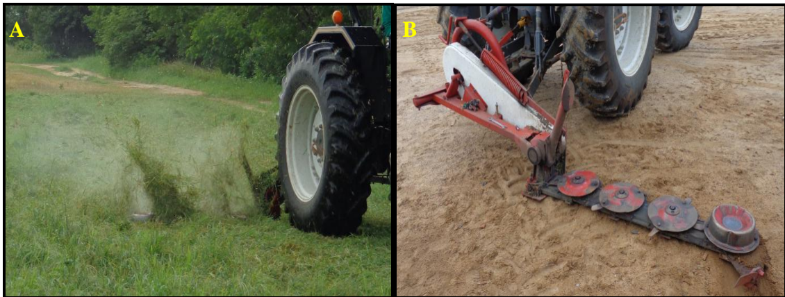
Figura 3 - Corte do capim (A); Segadora de disco modelo "SDN - 170" (B)
