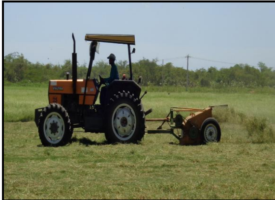
Figura 4 - Revolvedor-condicionador, fazendo a viragem do capim.
