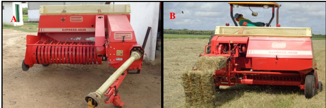
Figura 7 - Enfardadora, modelo; "express - 4030" (A); enfardadora recolhendo a forragem desidratada e enfardando (B)
