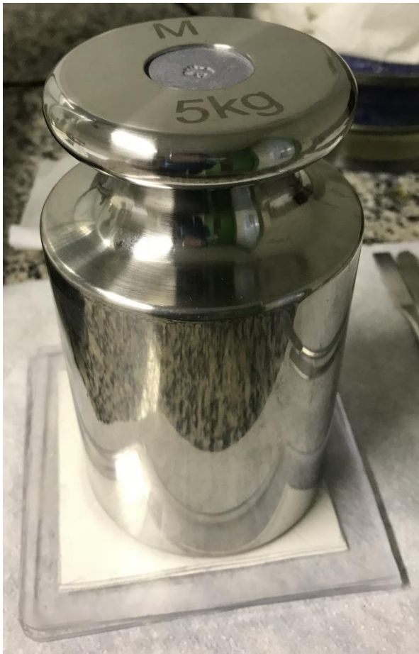
Figura 7 – Peso sob amostra e papéis-filtro
