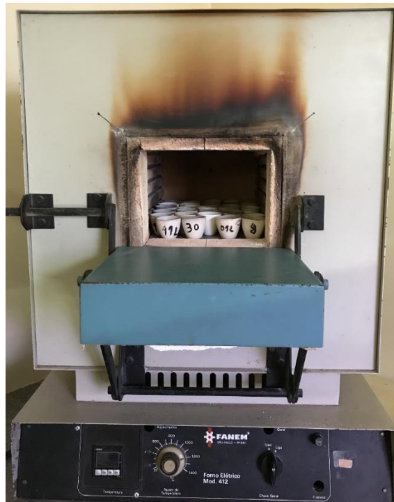
Figura 3 – Mufla com os cadinhos postos para incineração
