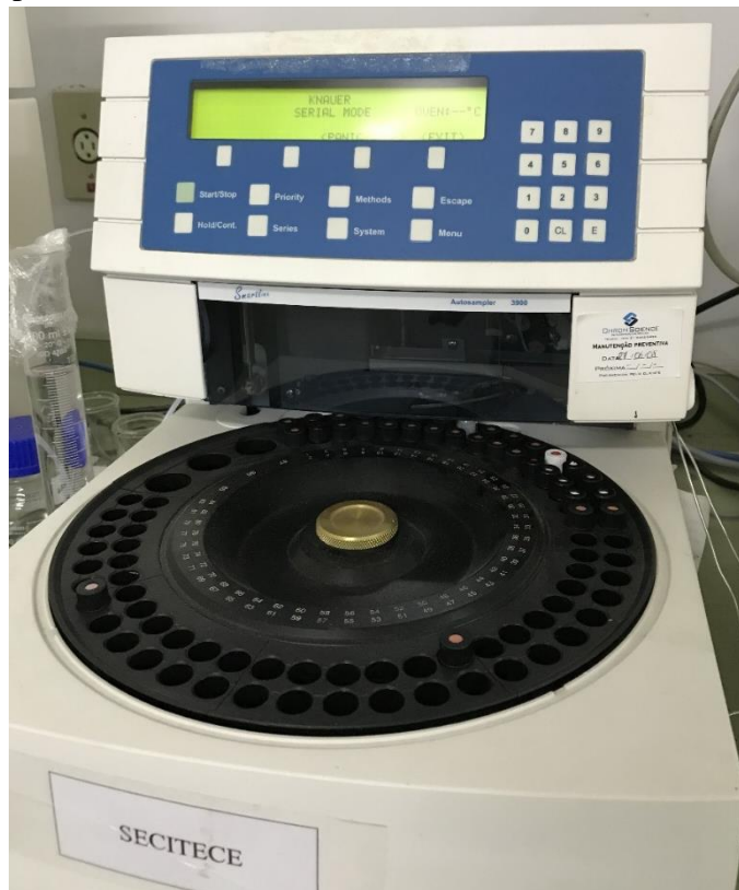
Figura 12 – Cromatógrafo com os vaio posicionados
