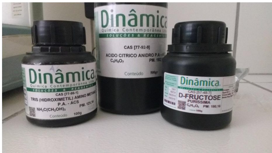
Figura 7: Mostrando os componentes do TRIS diluidor
