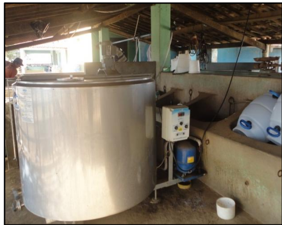
Figura 57 – Tanque próprio na sala de ordenha
