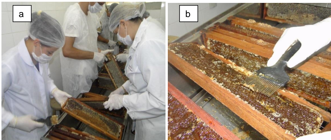
Figura 21 - Quadros sendo desoperculados na mesa desoperculadora (a), garfo desoperculador (b).
