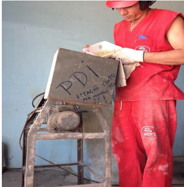
Figura 26 – Máquina que realiza o PDI
