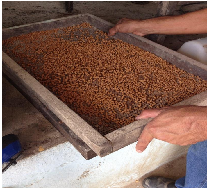
Figura 27 – Pellets íntegros na peneira
