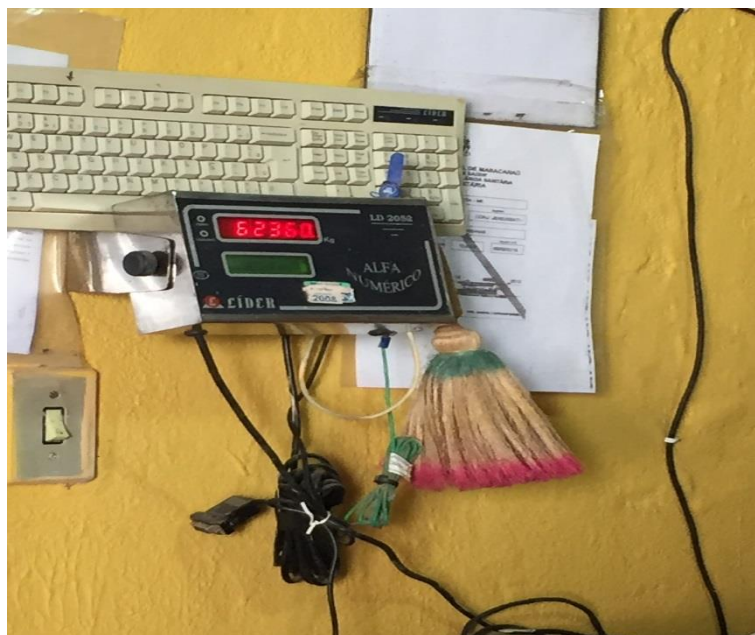
Figura 17 – Aparelho que mostra o peso dos caminhões
