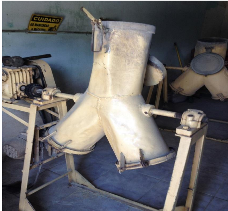
Figura 19 – Misturador em Y
