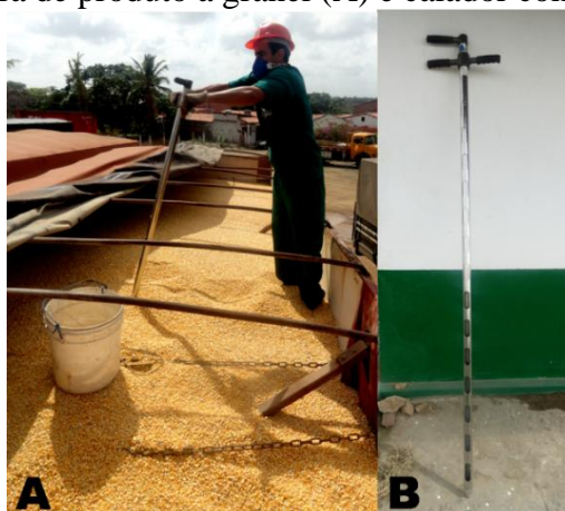
Figura 2 _ Coleta de amostra de produto a granel (A) e calador composto (B)
