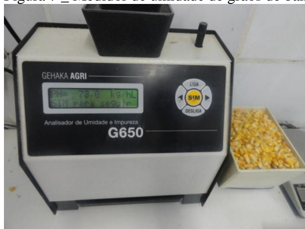
Figura 7 _ Medidor de umidade de grãos de bancada
