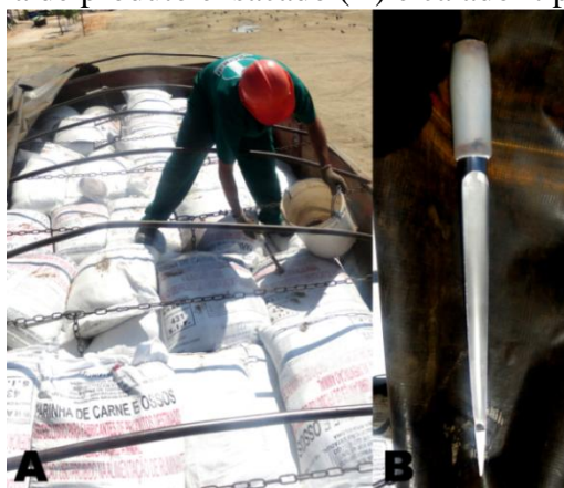
Figura 3 _ Coleta de amostra de produto ensacado (A) e calador tipo gaita (B)
