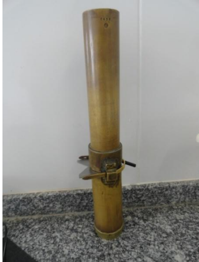
Figura 30 _ Cilindro para análise de densidade
