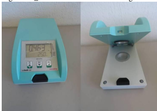
Figura 32 _ Analisador de atividade de água
