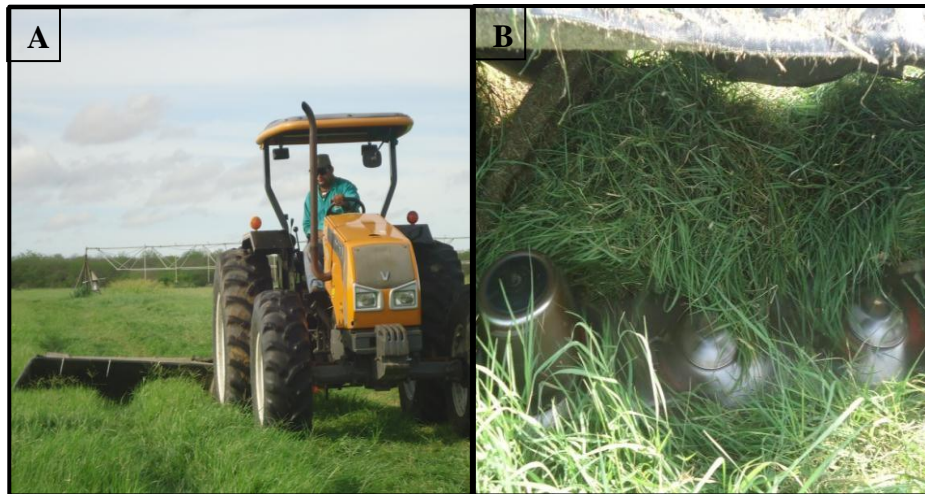
Figura 3 Corte do capim (A); Segadeira de disco (B)
