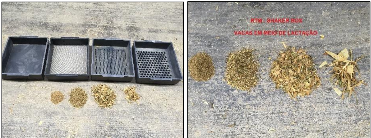
Figuras 26 e 27 – Avaliação do tamanho de partículas da ração com a Shaker Box
